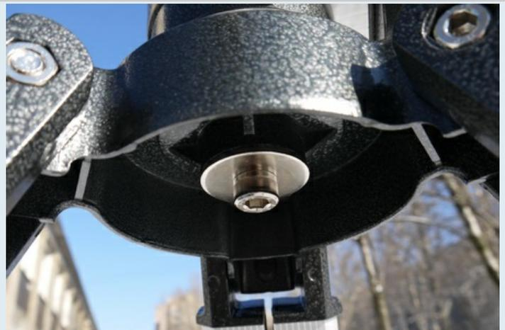
**Горизонтальная ось - ось высоты** - узел горизонтальной оси состоит из четырех соосных деталей: базы, тормоза, затяжной гайки и крепежной плашки под
