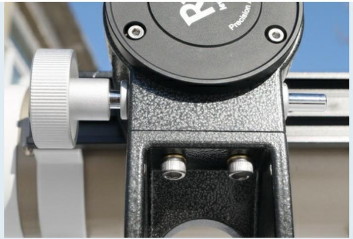
**Крепление пера полувилки к вертикальной (азимутальной) оси** - перекладина полувилки может быть прикреплена к узлу вертикальной оси или вертикально (хорошо для коротких труб или при наземных наблюдениях), или под углом 45 градусов (лучше при использовании длинных астрономических труб). Крепление осуществляется парой болтов с головкой под шестигранник. Тут также требуется надежное и осторожное крепление. Маховичок тонкой наводки по горизонтали на фотографии слева.
