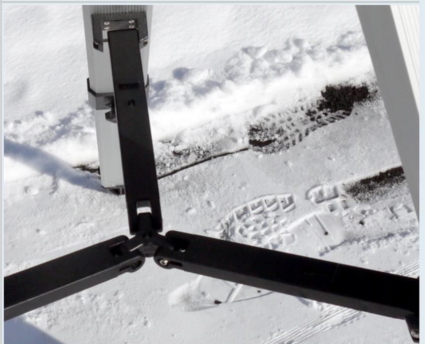
**Соединение базы треноги с монтировкой (ее азимутальной осью)** - монтировка притягивается к основанию треноги болтом с широкой шайбой и головкой под шестигранник.
