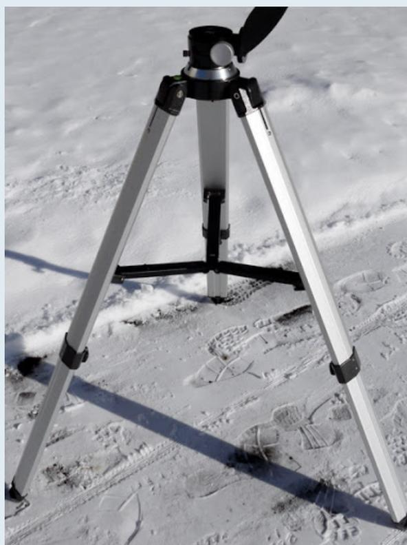
**Опора** - окончание ноги усилено заглушкой в виде тупого металлического конуса со ступенькой для вдавливания ног в грунт
