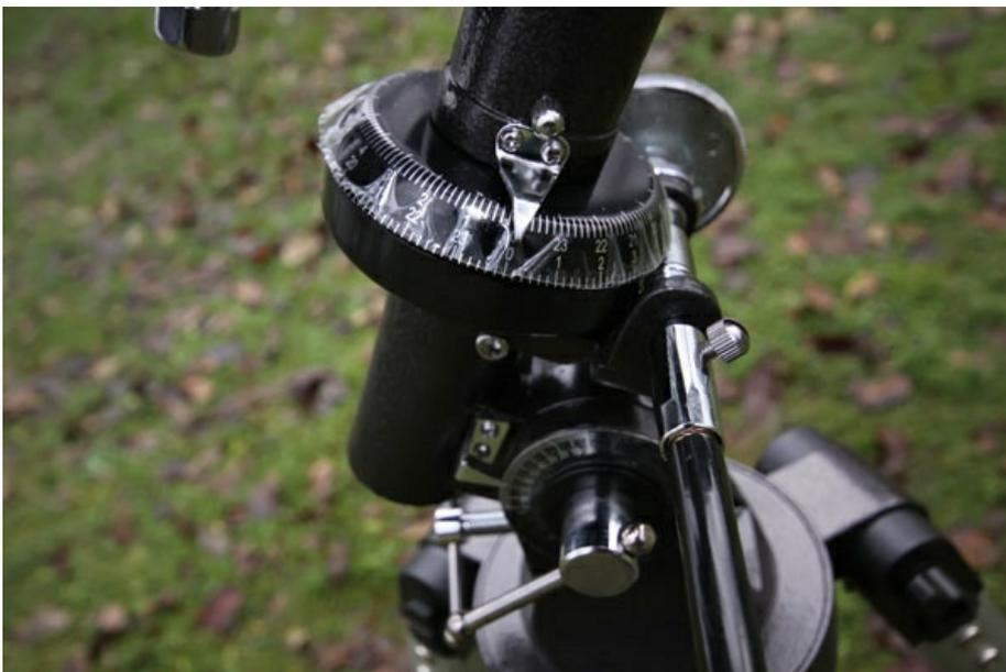
Перед началом наблюдений выставите угол полярной звезды, то есть географическую широту местности, в которой вы наблюдаете.
