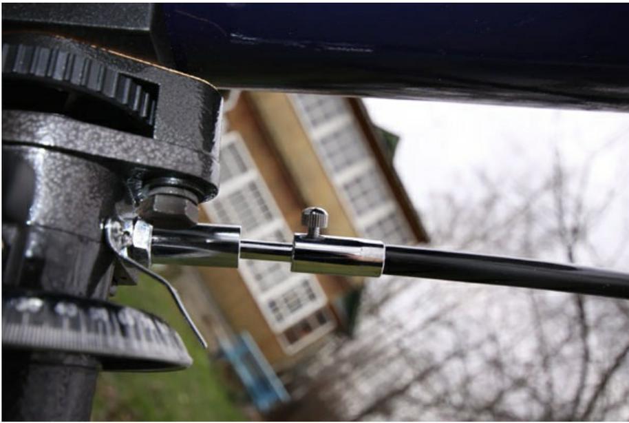
Тщательно балансируйте телескоп! Труба не должна начинать самостоятельное движение по осям при ослаблении винтов.
