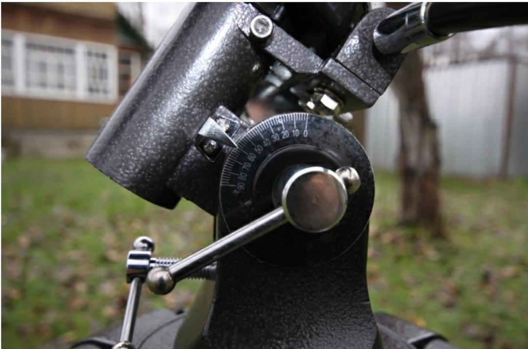
Если вы приобрели электропривод часовой оси, установите его на длинную втулку монтажки и введите шестерни в
