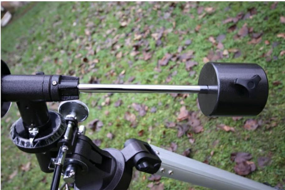
Во время сборки телескопа обязательно затяните сильнее винт крепления монтировки к треноге.
