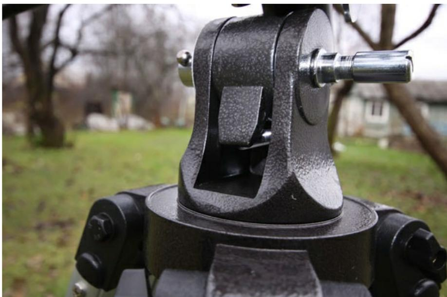
Небольшое количество смазки должно быть везде, где только есть резьбы на монтировке.
