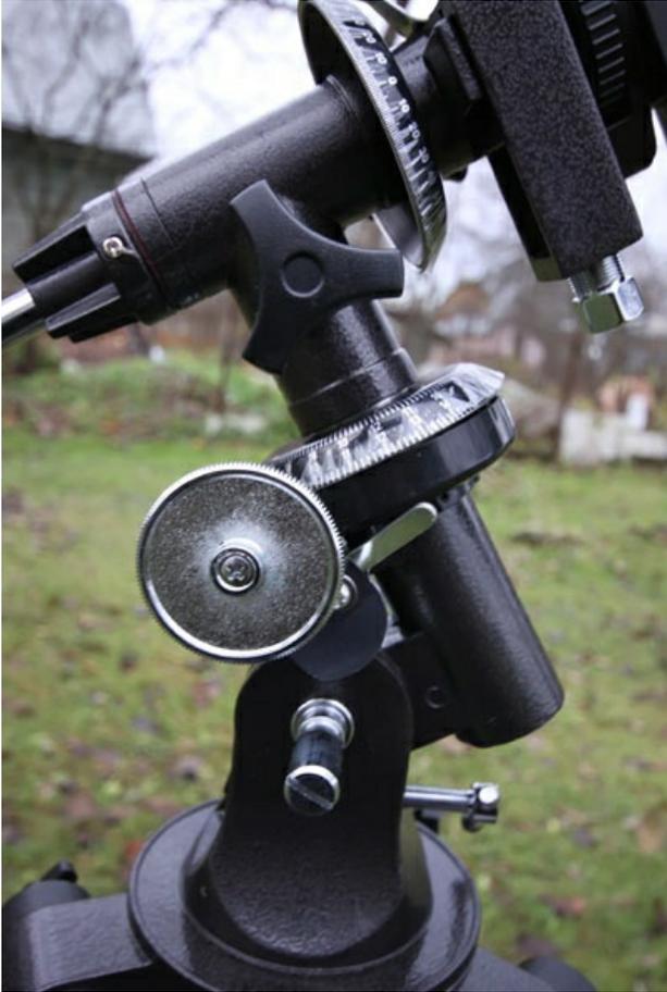
В движении по оси прямого восхождения участвует червячная передача. Несколько капель масла, нанесенные на нее, будут способствовать плавности хода.
