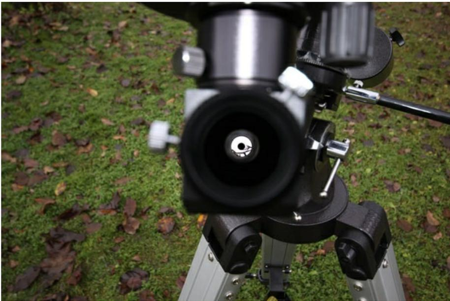
Снаружи винты крепления надежно фиксируют окуляр в диагональном зеркале, которое ломает световой пучок на 90 градусов. Благодаря этому излому мы с вами можем с комфортом наблюдать небесные объекты, расположенные высоко у нас над головой в околозенитной области.
