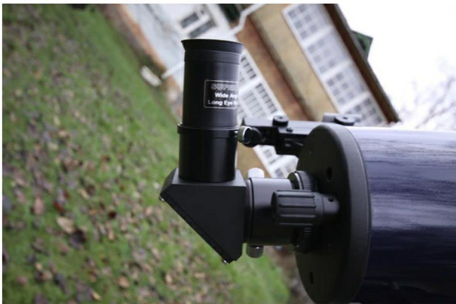
Заглянем в окулярный узел, где в цепочке отражений зеркала строят изображение далеких сокровищ Вселенной. Прекрасно видно экранирование в системе. Присмотритесь к зеркальному слою, напыленному с тыльной стороны мениска, отражающему лучи от главного зеркала и передающему их дальше в окулярный узел.
