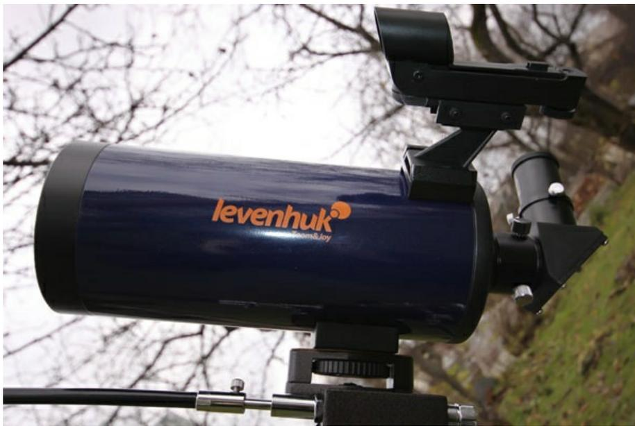
Окулярный узел присоединен к заднему фланцу трубы, здесь же размещается фокусирующее устройство в виде длинного винта, который двигает главное зеркало телескопа вдоль оптической оси, производя наводку на резкость.
