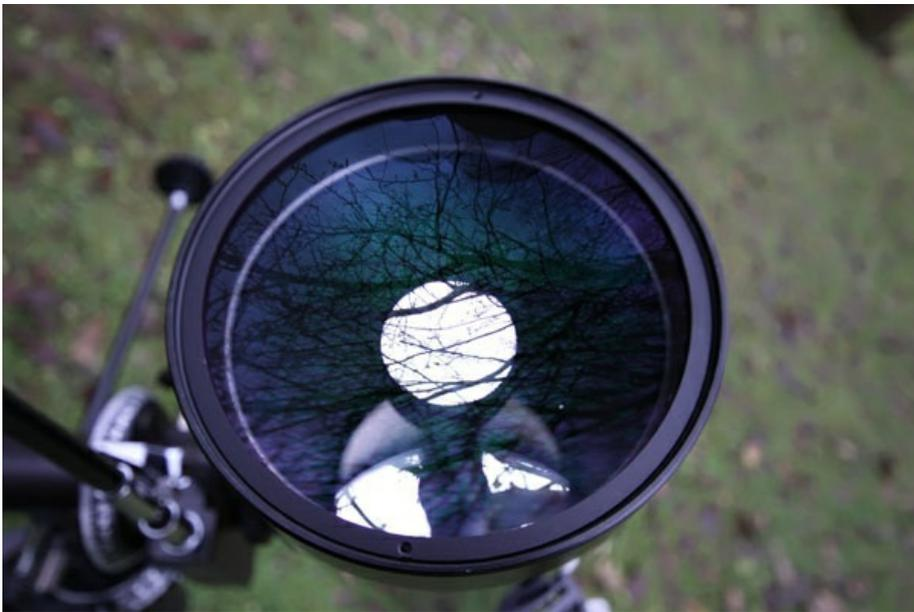
Внутри труба хорошо зачернена, оптические элементы снабжены блендами для отсеечения паразитных лучей, а снаружи покрашена эмалью в цвет «синий металлик».
