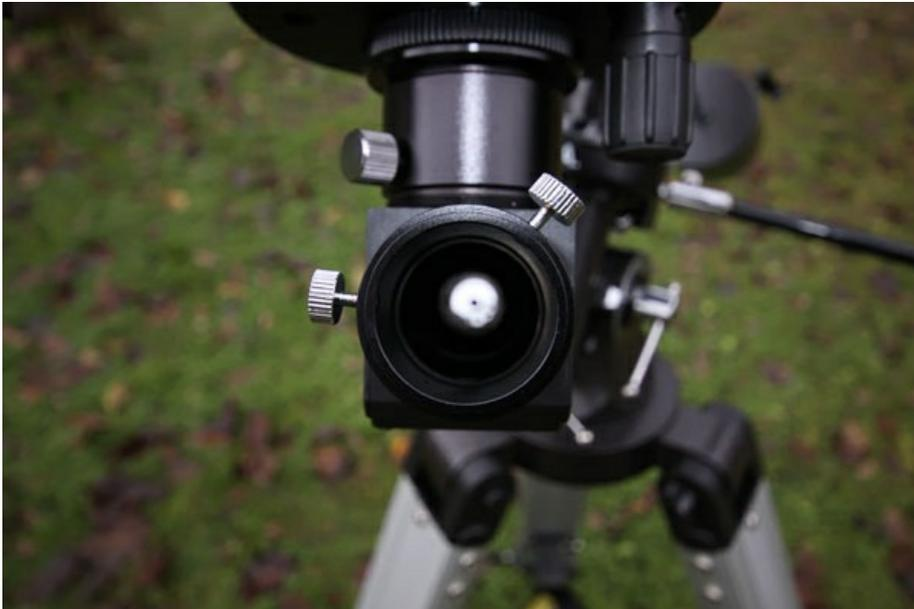
Во время сборки телескопа плотно зафиксируйте диагональное зеркало двумя винтами.
