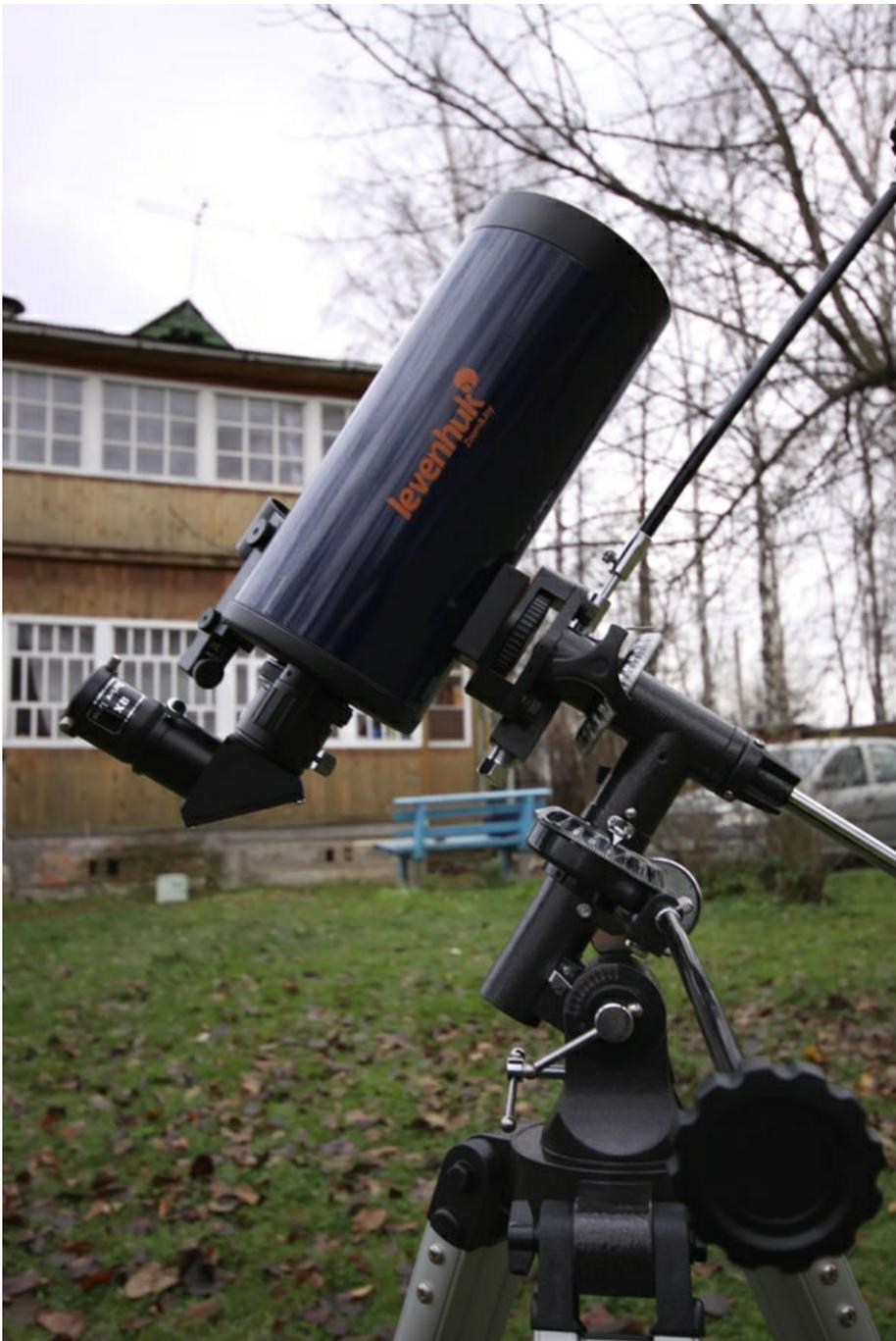
Для автоматического слежения за звездным небом требуется электромотор на ось прямого восхождения, и его вы сможете
