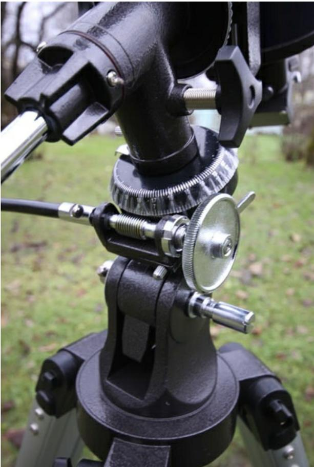
Между винтом выставления угла полярной оси и корпусной деталью нанесите небольшое количество густой смазки.
