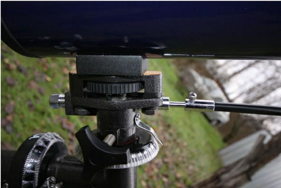
Сама монтировка очень проста и понятна, снабжена размеченными кругами по обеим осям. Это дает возможность наводиться на объект по его известным координатам, используя указатели на корпусе, винты фиксации осей и ручки тонких движений.
