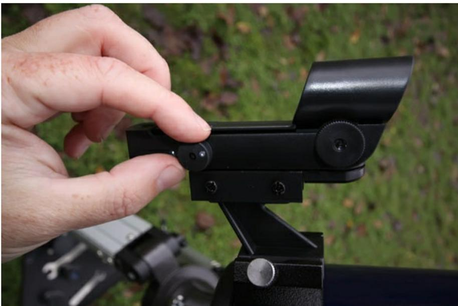
Поставьте в трубу слабый окуляр и наведите телескоп на объект, удаленный от вас примерно на 500 метров. Затем при помощи двух винтов отцентрируйте по нему искатель. Наводиться на объекты следует сначала при помощи искателя, а уже затем, глядя в окуляр, выполнять коррекцию ручками тонких движений.
