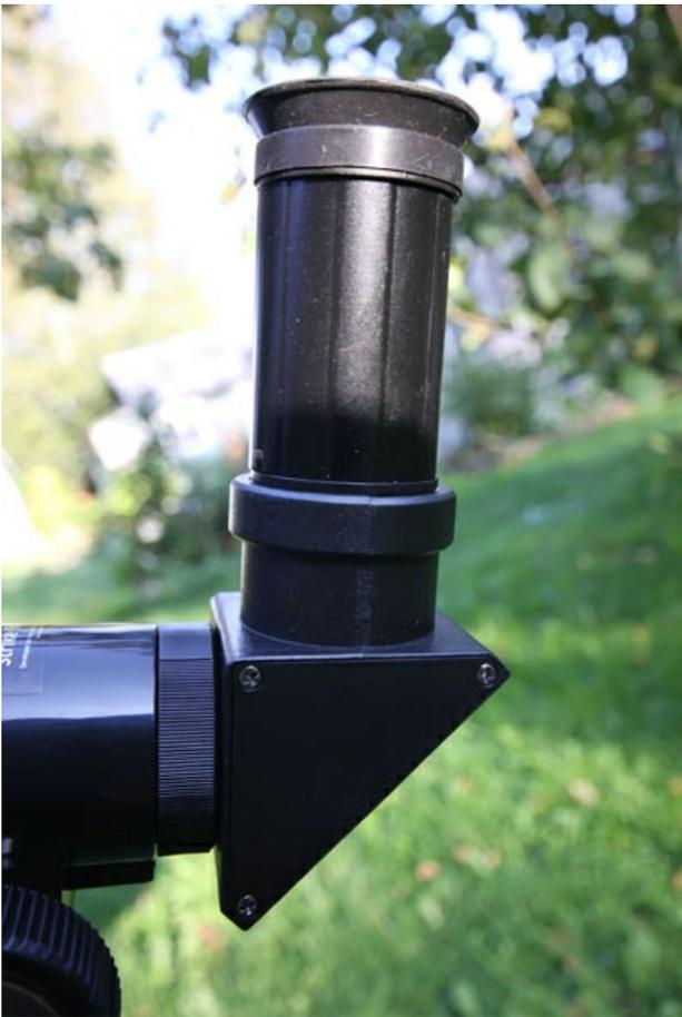
Само диагональное зеркало изготовлено из пластика. Окуляр прижимается специальным винтом.
