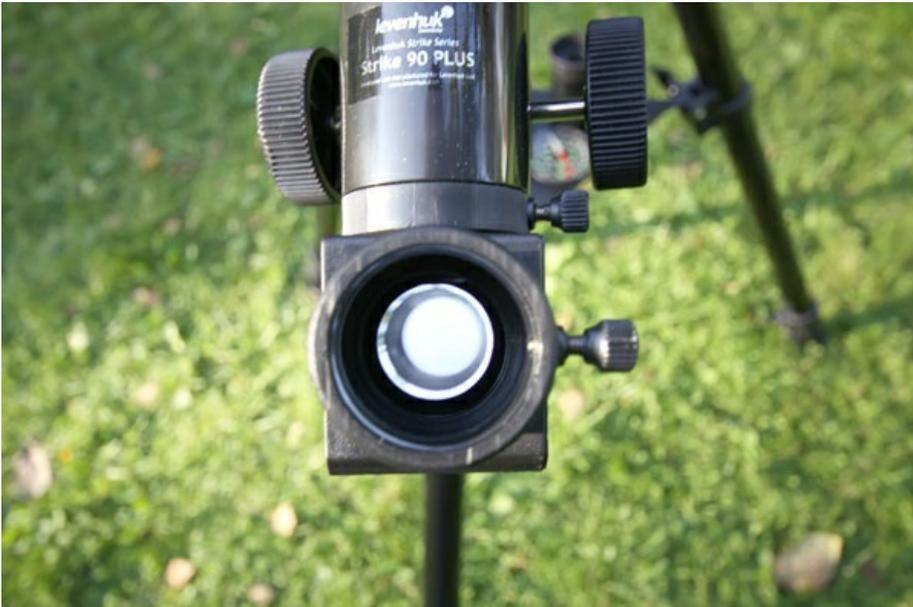
Искатель устанавливается на трубу в специальный паз и крепится при помощи двух винтов.
