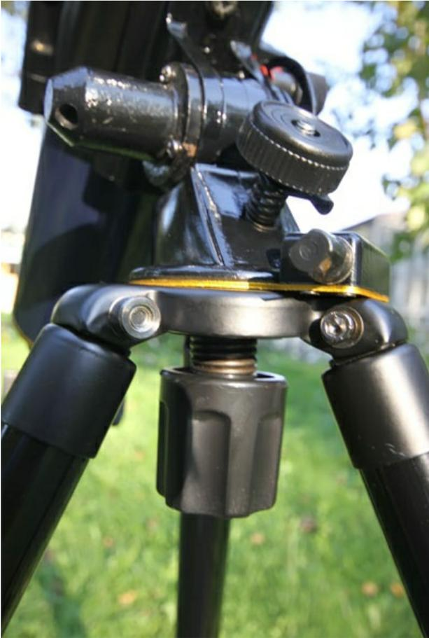
Полочка для принадлежностей крепится при помощи трех винтов к треноге и является элементом, придающим дополнительную жесткость всей конструкции.
