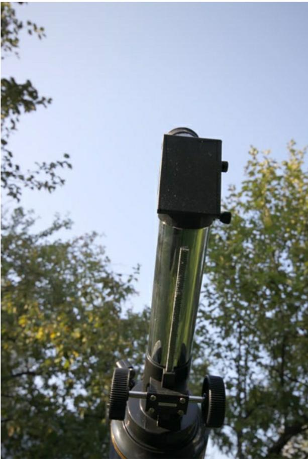
Фокусер сделан из композитных материалов – пластика и металлизированной фольги. Крепление окулярной части к нему осуществляется при помощи пластикового винта.
