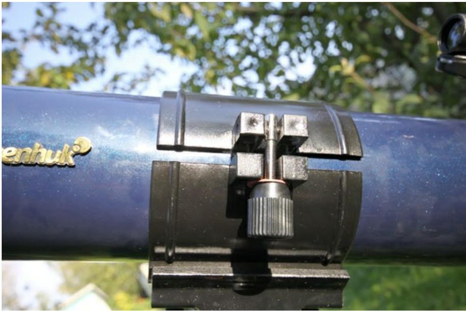
Искатель с красной точкой использует принцип лазерной указки. Перед началом наблюдений необходимо выставить соосность трубы и искателя по объекту, удаленному не менее чем на 300 метров. Удалите бумажную прокладку между контактами и включите искатель.
