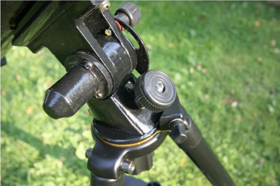
В управлении монтировка очень проста. Регулировать монтировку по высоте и азимуту можно при помощи винтов. Монтировка установлена на прочный устойчивый металлический штатив и крепится к его основанию объемной фигурной гайкой.
