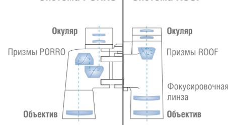
**PORRO:** Классический полевой бинокль, более простая и популярная система. Призмы системы PORRO легче в производстве, а потери света в системе призм практически равняются нулю, что дает лучшее изображение. Однако бинокль становится более широким и тяжелым.
