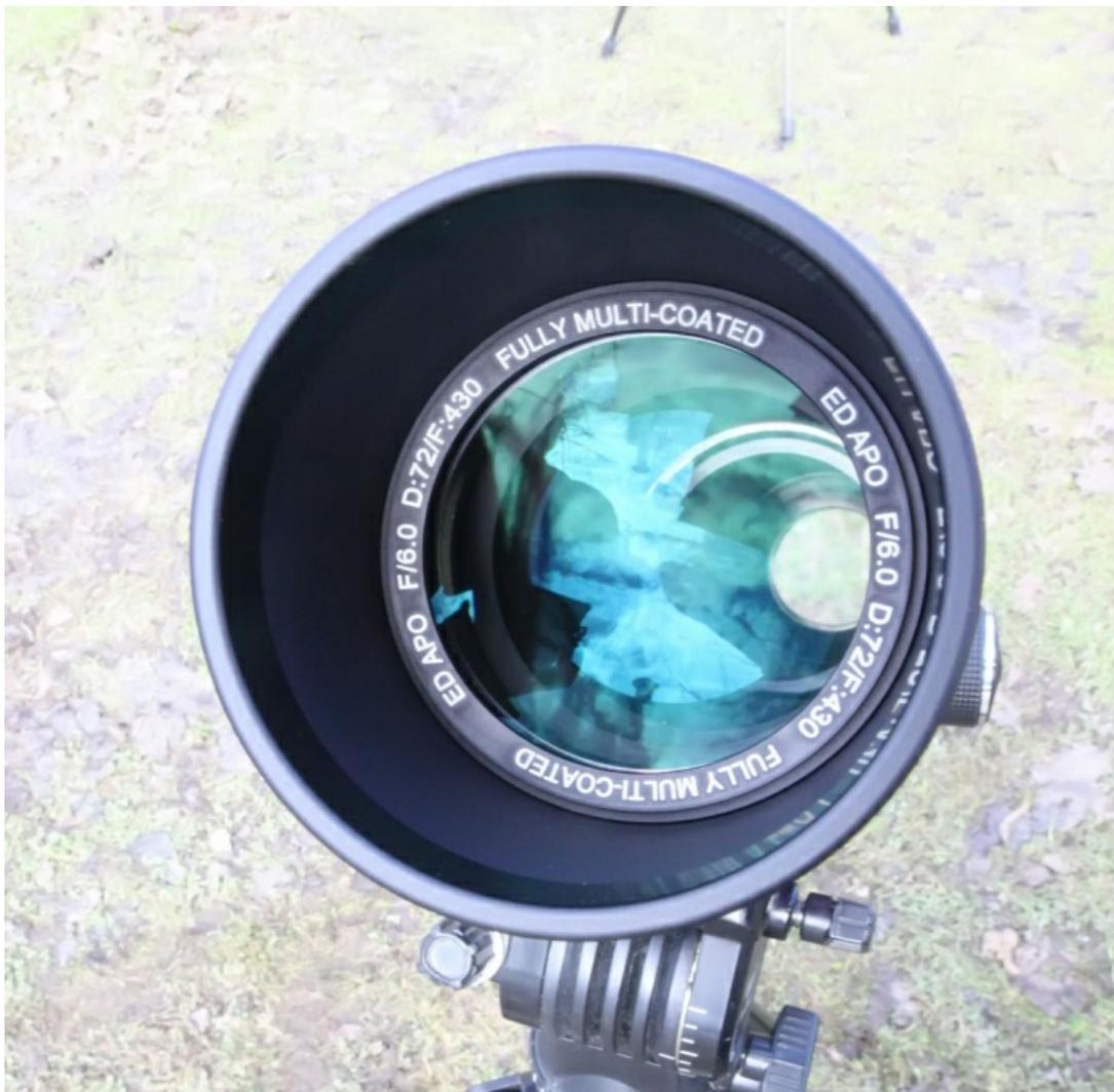
Внутри трубы установлены диафрагмы, отсекающие паразитные лучи. Алюминиевая труба и корпус фокусера имеют эффектное блестящее анодированное напыление. Если бы проводился конкурс красоты среди телескопов, то наверняка Levenhuk Ra R72 ED Doublet OTA получил бы на нем главный приз!
