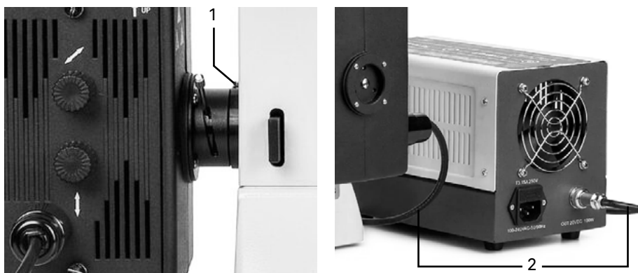
Рис. 4с. Установка блока поджига ртутной лампы
