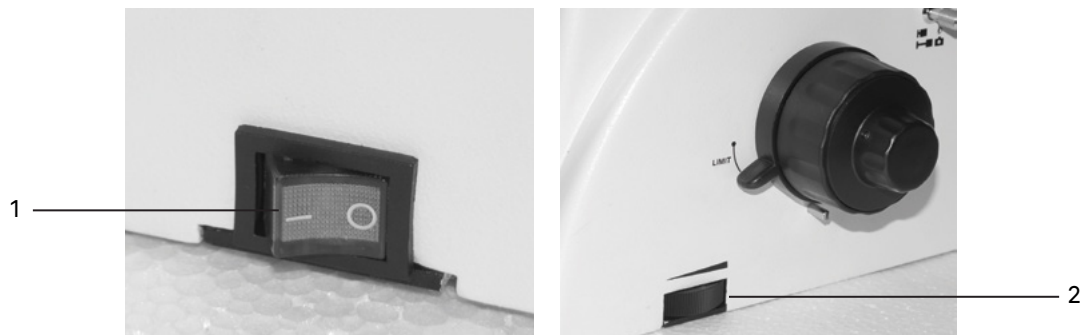
Рис. 5. Включение освещения и регулировка яркости горения лампы
