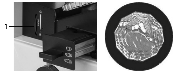
Рис. 22. Регулировка полевой диафрагмы
