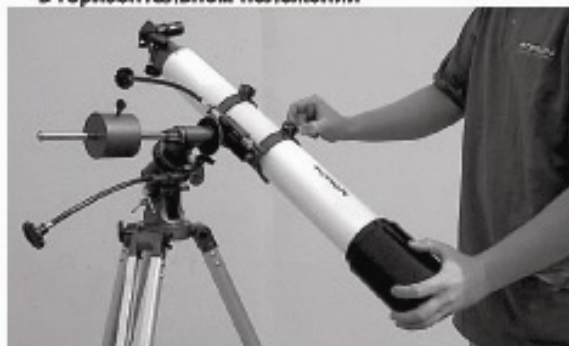
Рисунок 3д. Аккуратно уравнивайте телескоп вдоль оси склонения. Как показано на рисунке, телескоп не сбалансирован (качается)
