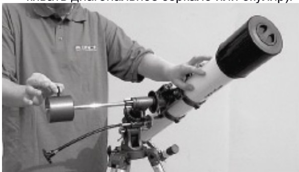
Рисунок 3а. Аккуратно уравнивайте телескоп вдоль оси прямого восхождения, путем продвижения противовеса вдоль его стержня
