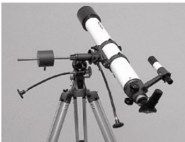
Рисунок 6а. Телескоп направлен на юг. Обратите внимание, что во всех положениях монтировка и тренога остаются неподвижными; двигаются только оси склонения и прямого восхождения
