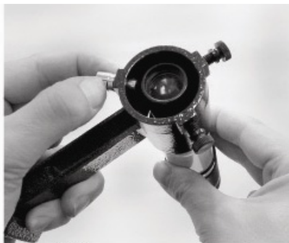
Рисунок 2б. Вставка искателя в кронштейн
