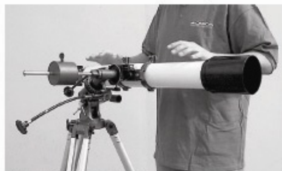
Рисунок 3е. Телескоп уравновешен вдоль оси склонения и остается горизонтальным
