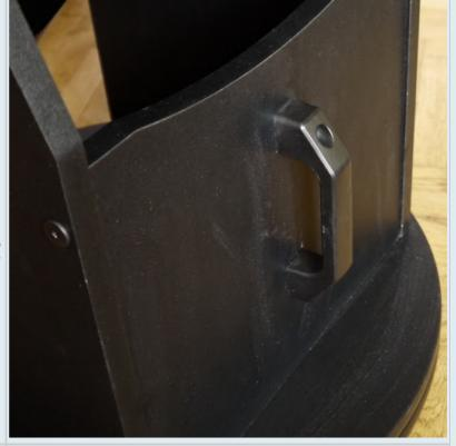
Высота перьев монтировки 580 мм, перекладины, которая соединяет их 330 мм. На фото внутри перекладины видна пара гаек-бабочек для к которым снаружи прикручена ручка переноски. Внизу основания выступает головка винта-оси стягивающего вращающуюся часть монтировки и ее основания. Рукоятка позволяет отчасти регулировать силу трения в азимутальном подшипнике монтировки.
