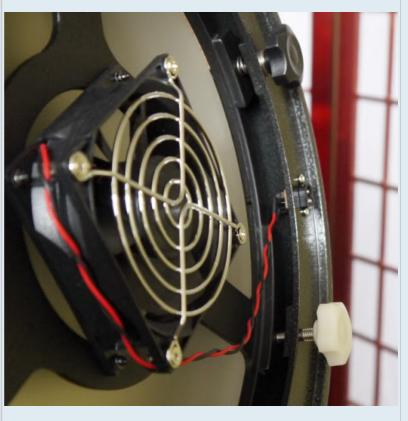
стопорных винтов приводит к изрядной чувствительности состояния юстировки к силе затяжки стопорных винтов. Ну или по другому - силой затяжки стопорных винтов мы как-бы производим финишную юстировку.
