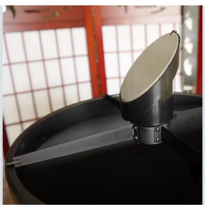
Передний торец трубы усилен прочным силуминовым (?) фланцем, который крепится к стальному листу трубы 6-ю винтами М4х5. Ось фокусера расположена в 140 мм от переднего края трубы. Паук крепится к стенкам трубы 4-мя блестящими колпачковыми гайками, которыми можно регулировать натяжение растяжек, для лучшей стабильности в положении оправы вторичного зеркала.
