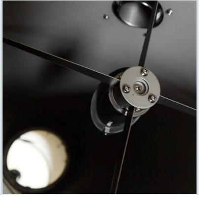
ложе в свою очередь крепится к юстируемой части оправы, а та в свою очередь к базе оправы подвешенной на растяжках. Диаметр тени оправы составляет 66 мм (центральное экранирование 26%), размер отражающей части зеркала 87х62 мм. Для точного согласования оси фокусера и главного зеркала служат 3 юстировочных винта - их головки видны на фотографии. Этими винтами добиваются того, чтобы при взгляде из центра фокусировщика главное зеркало было видно целиком без обрезания.
