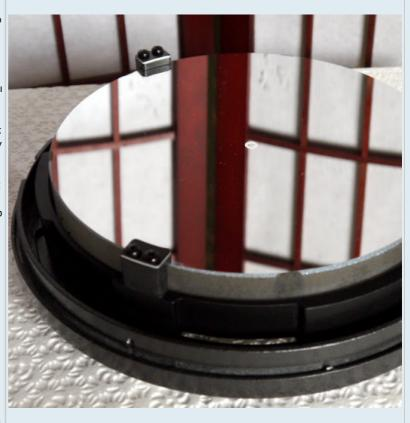
Главное зеркало от выпадения из оправы предохраняется тремя Гобразными резиновыми лапками. важно следить, чтобы зеркало не было внатяг притянуто этими лапками к основанию оправы. Должен между выступом предохранительной лапки и зеркалом должен быть зазор порядка полумиллиметра иначе возможны пережатия зеркала с искажениями его фигуры
