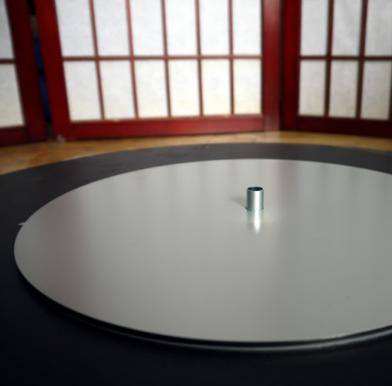
от времени разбирать азимутальный подшипник монтировки и следить за состоянием как роликов так и стальных листов. В частности, не мешает время от времени смазывать листы спреем -смазкой для велосипедных цепей. При сильном износе эти стальные пластины можно просто перевернуть предоставив таким образом роликам кататься по не разрушенной дорожке.
