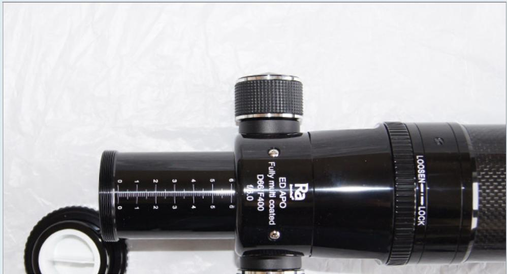
На трубке фокусера имеется резьба такая же как на 1.25" хвостовиках Шмидт-Кассегренов
