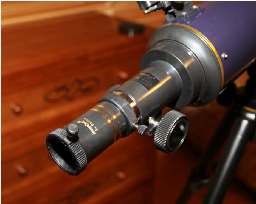
В фокусере установлена линза Барлоу.
