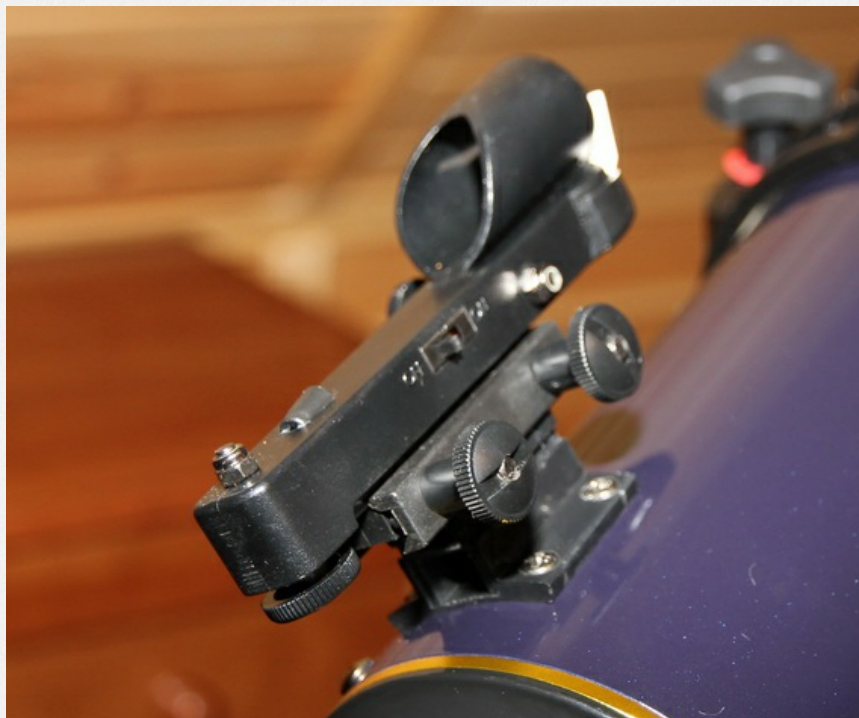
С помощью крепления «ласточкин хвост» на трубе телескопа монтируется искатель с красной точкой
