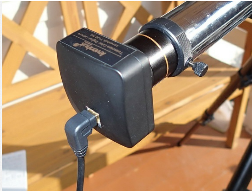
Камера установлена в фокусере телескопа вместо окуляра
