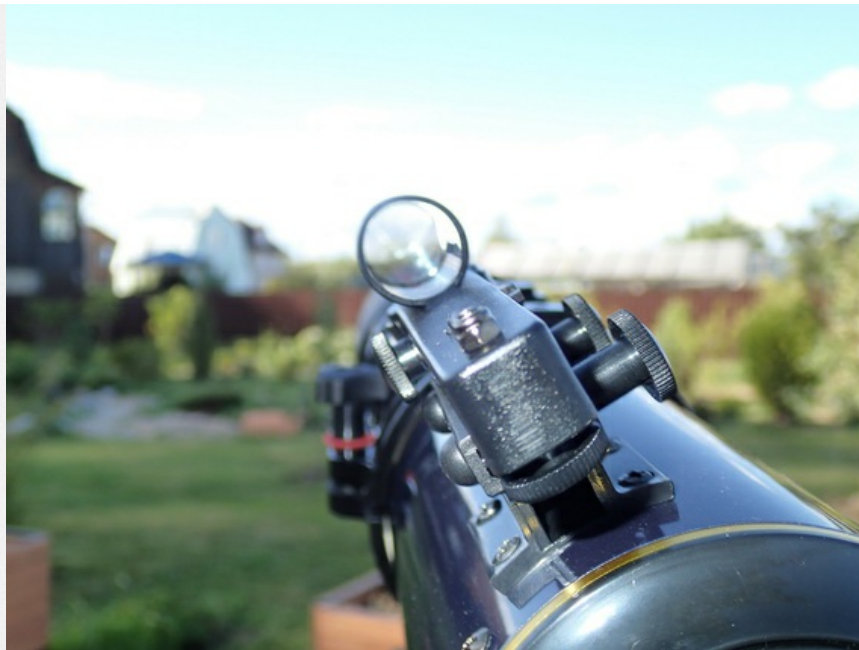
Наводим искатель на удаленный объект
