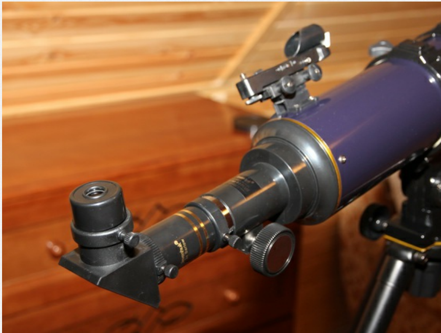
Оптическая сборка «линза Барлоу – диагональное зеркало – окуляр».
