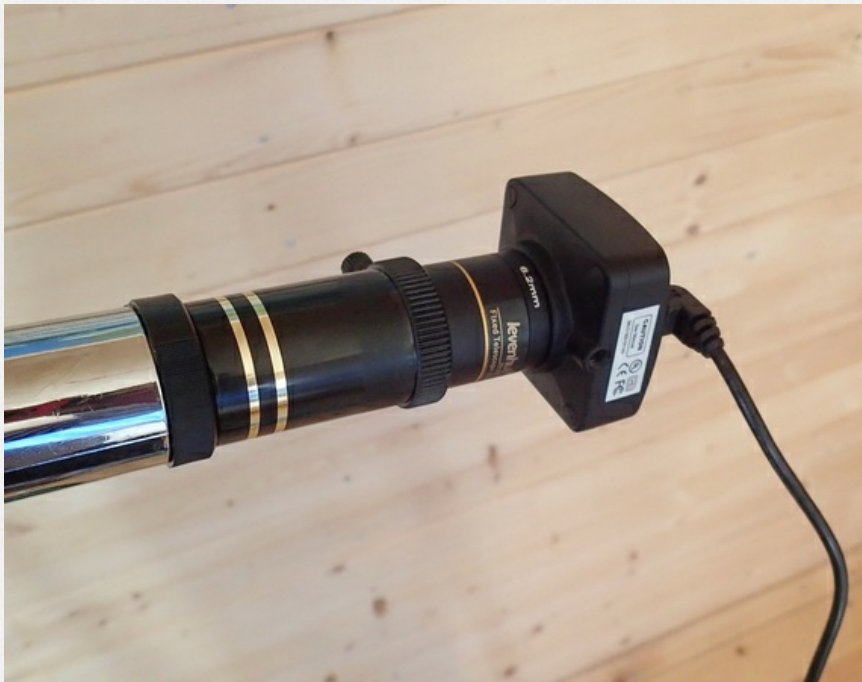
Для того, чтобы повысить увеличение, подключаем камеру к телескопу через линзу Барлоу
