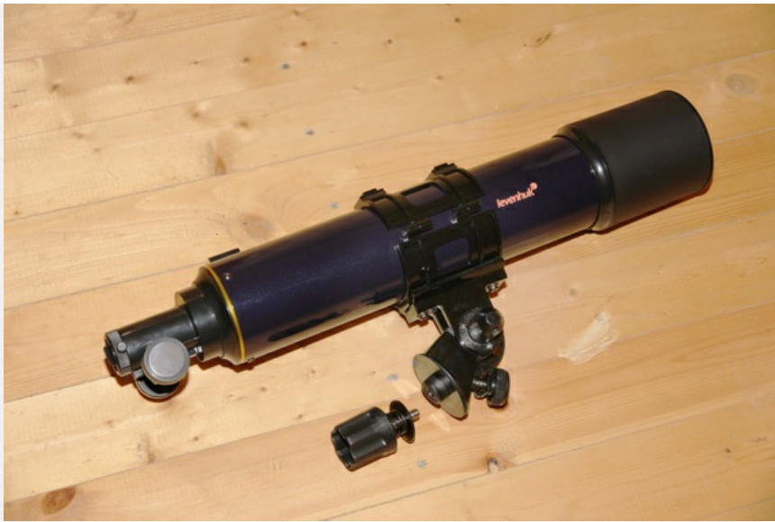
В нижней части снимка – винт с подпружиненной шайбой, которым труба телескопа крепится к треноге
